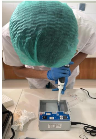
Pemipetan sampel ke dalam sumur agarose
