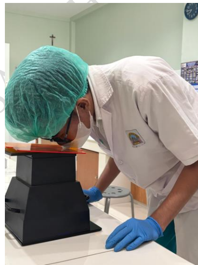
Pembacaan hasil elektroforesis pd alat UV Transluminator/Geldoc
