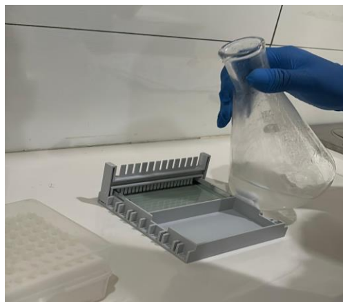
Penuangan media agarose pada cetakan
